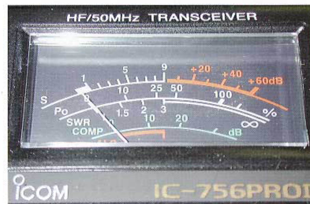
Un S-mètre, oui, mais le calibrage testé ici reste correct avec des points S oscillant entre 5 et 7dB selon les bandes et la valeur initiale de l'aiguille (erreur relative).
